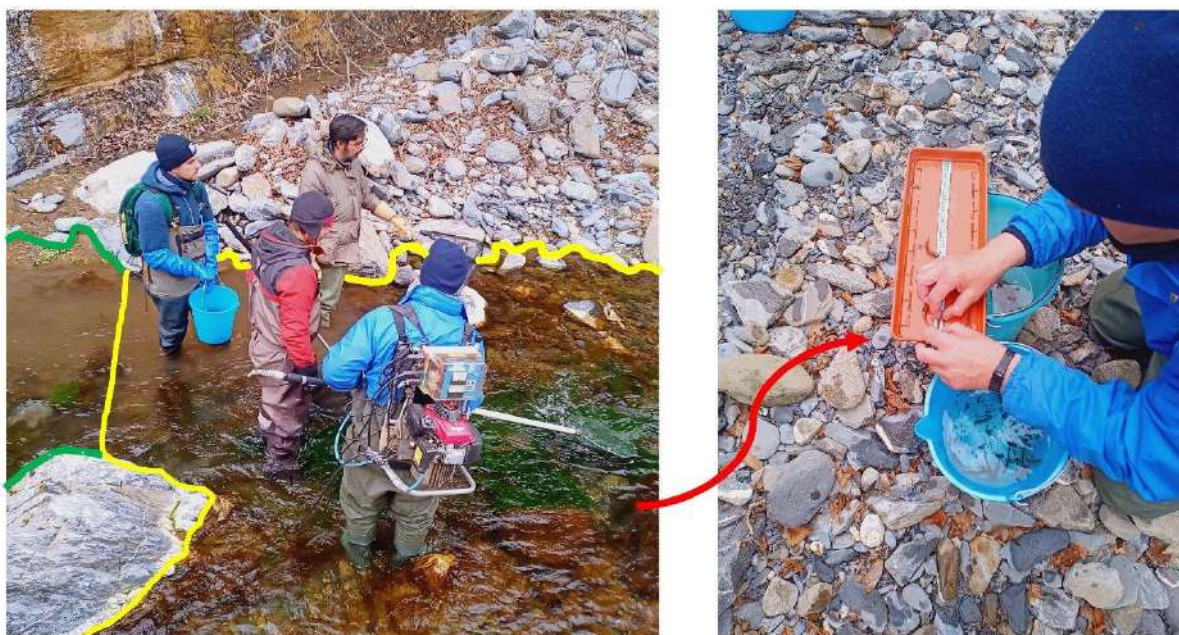
Figura 15. – (A sinistra) Campionamento ittiofaunistico tramite elettrostorditore a motore e rappresentazione grafica del contorno georiferito delle UMI tramite la tecnica di mobile mapping (MLG ISPRA 154/2017). (A destra) Raccolta degli esemplari catturati in un secchio contenente acqua e compilazione della scheda per il censimento delle specie presenti.
