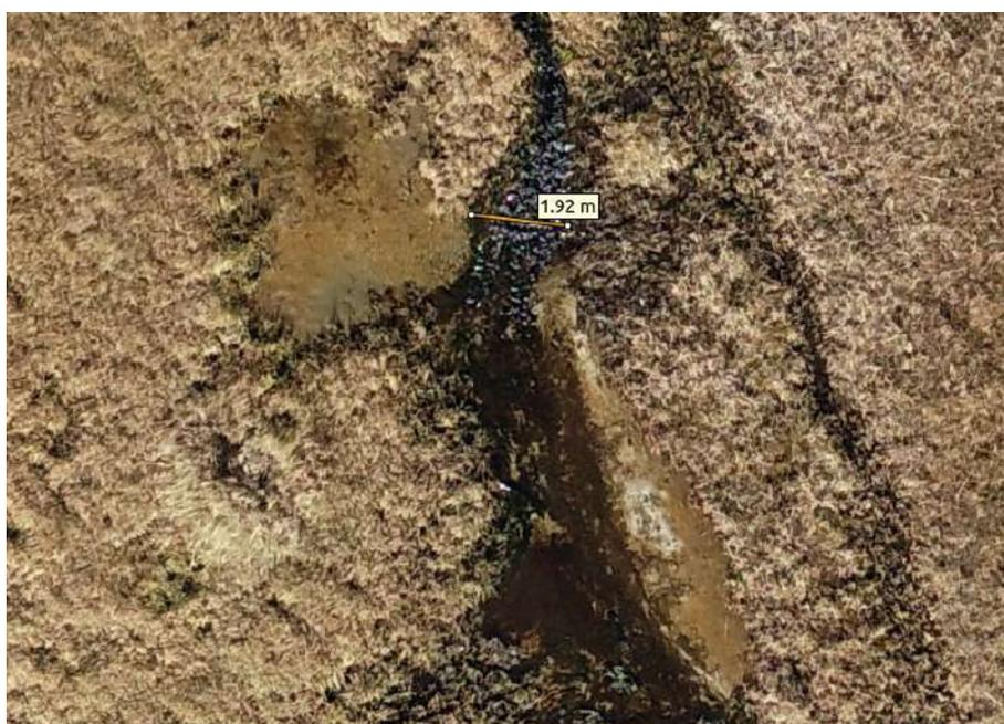
*Fig. 3: esempio di ortomosaico (colori RGB) derivato da ripresa APR (ZSC IT1204032 – Talweg della Val Ferret) e prodotto con risoluzione pari a 2,5 cm/pixel. La possibilità di effettuare misure sul supporto digitale è l'elemento qualificante del metodo.*
