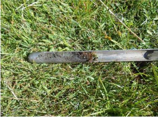
Foto 2.2.1.2.2. Campionamento di suolo mediante trivella manuale. Foto © Ilaria Pozzi
