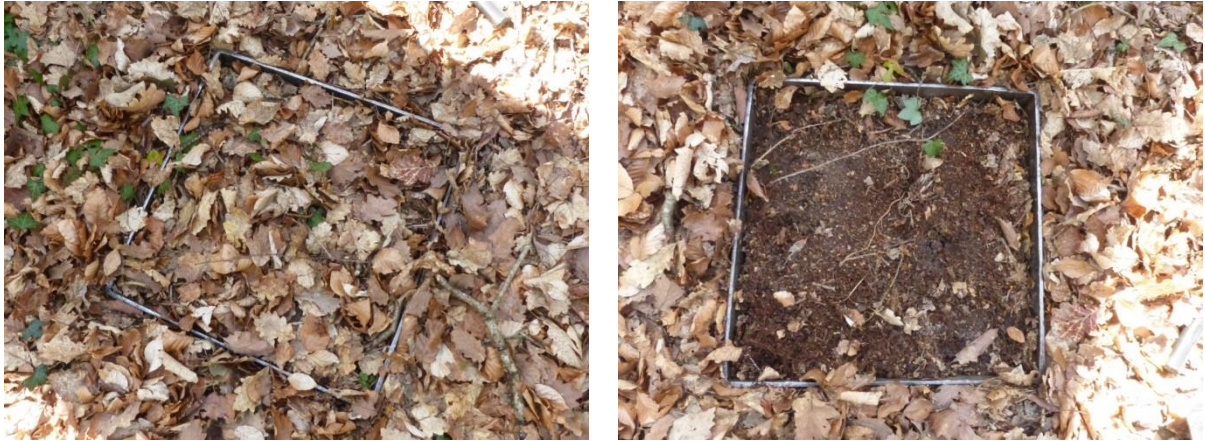
Fig. 5 et 6 : exemple de quadrat de 50x50x10 cm en place dans la litière, puis le sol une fois la litière prélevée (les deux substrats étant mis chacun dans un sac poubelle résistant pour le transport), d'après IORIO & RACINE (2018).
